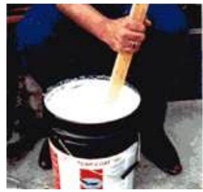
A MEDIDA QUE VA PULVERIZANDO, MANTENGA EL TEMP-COAT® MEZCLADO. USE UN PALO O UNA PALETA PLANA
